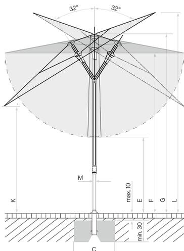
Revestimiento de cobertura suelto máx. 10 cm, grosor del hormigón mín. 30 cm (controlar la profundidad del hielo), Garantizar la salida de agua
